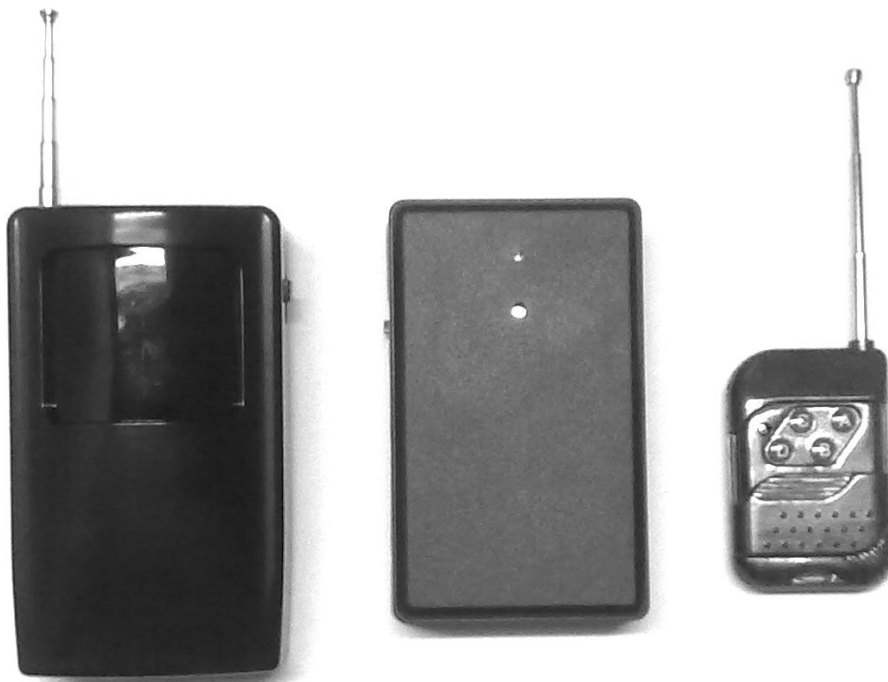
Kuva 1: Riistahälyttimen yksiköt vasemmalta oikealle: Lähetin/liiketunnistin, vastaanotin/hälytin ja kauko-ohjain.
